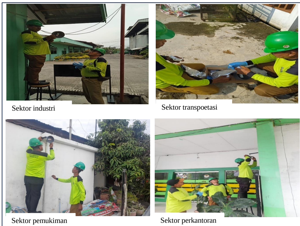
Gambar Pemasangan alat uji kualitas udara passive sampler di berbagai sektor
